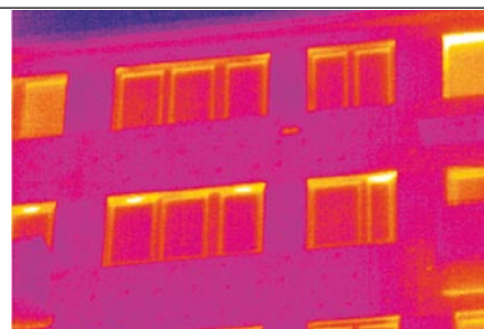
Okna o różnej jakości na 6 i 7 piętrze tego samego budynku, na tej samej elewacji. Po prawej stronie widoczne rozszczelnienia okien w górnej krawędzi. Wykonano przy pomocy obiektywu o kącie połowym 12°
