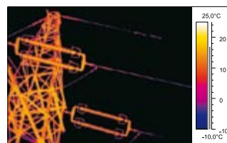
Linia 110kV. Kontrola złączek linowych. Termogram wykonany kamerą termowizyjną zaopatrzoną w teleobiektyw 12st
