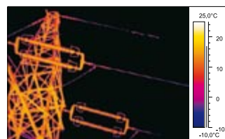
Linia 110kV. Kontrola złączek linowych. Termogram wykonany kamerą termowizyjną zaopatrzoną w teleobiektyw 12st
