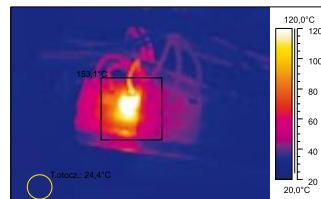
Rozdzielnia nn. Wada złącza do wyłącznika nadmiarowo-prądowego
